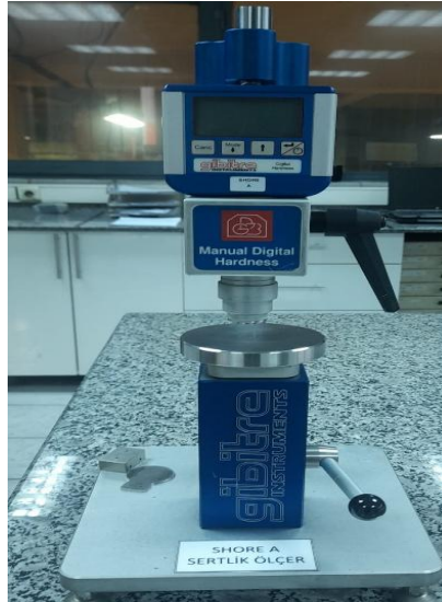
Görsel 7. Shore A sertlik ölçüm cihazı (shoremetre).
