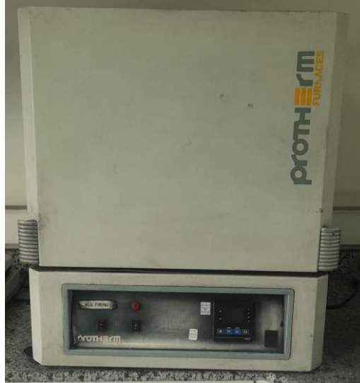
Görsel 5. Kül tayini için kullanılan fırın.
