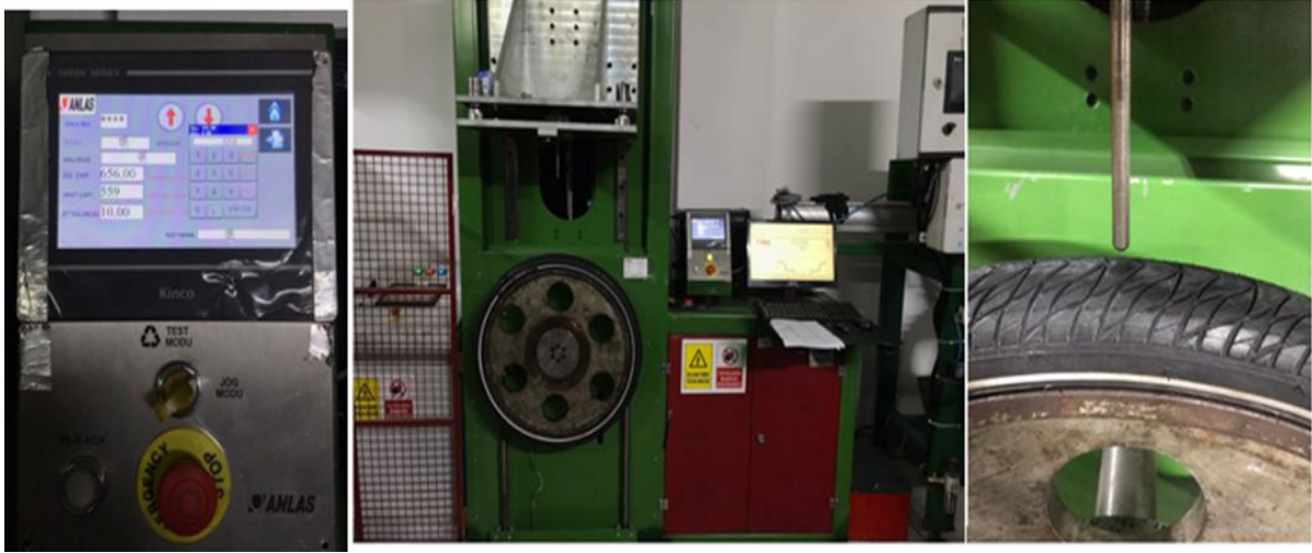
Görsel 8. Plunger Endurance (Lastik Delinme Enerjisi) Test Cihazı.
