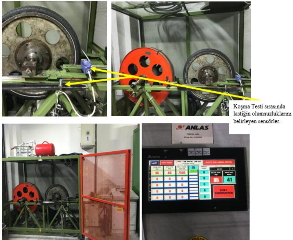
Görsel 7. Running Endurance (Dış Lastiğin Yol Mukavemeti Tayini, Koşma Testi) Testi.
